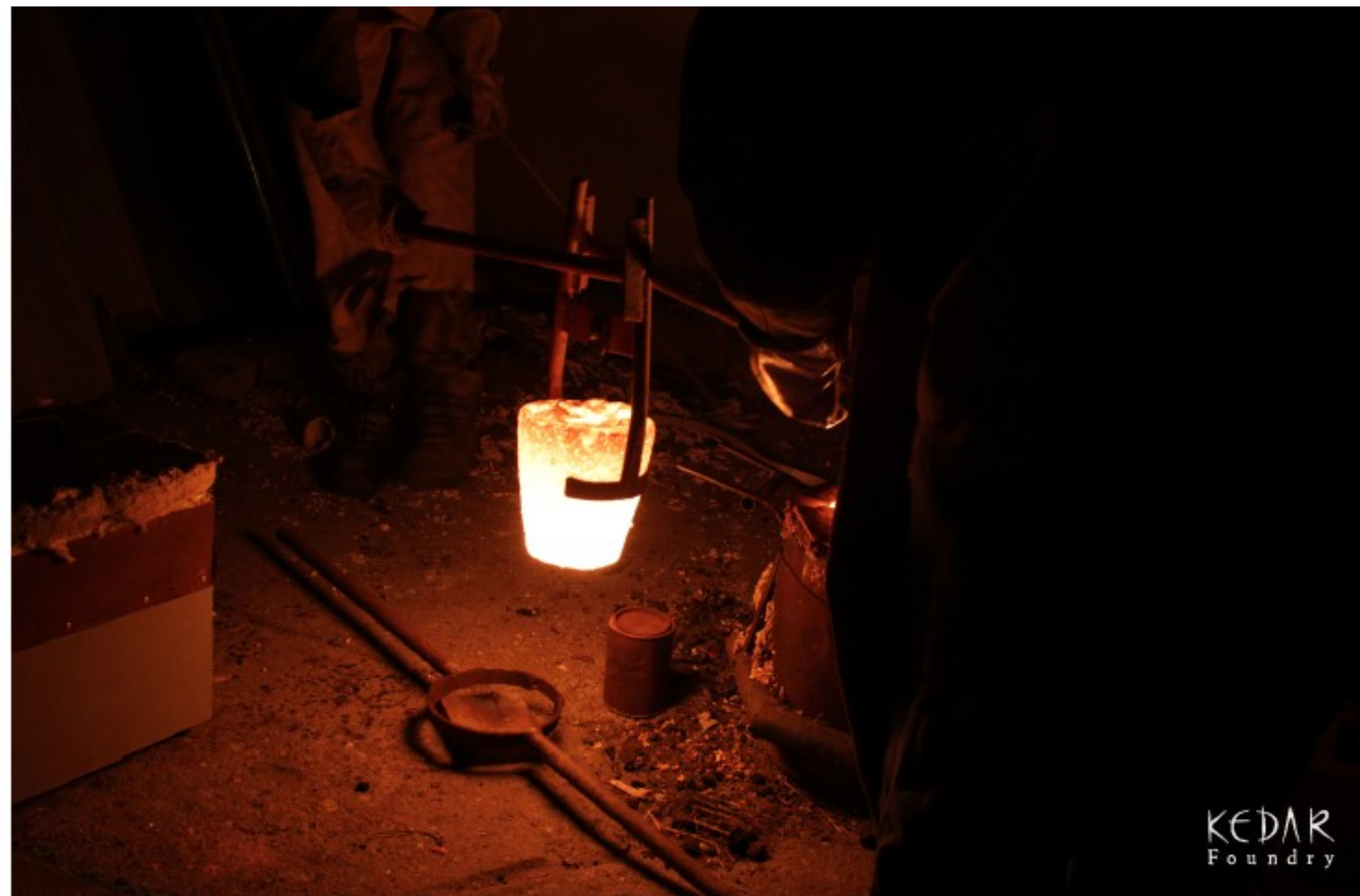
Obr.4: Vyjímání tavícího kelímku před umístěním do licího oka
