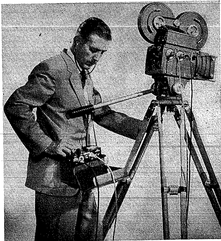
c) Snímání obrazu a současný záznam zvuku na magn. stopu na filmu 16 mm zvuk. kamerou Auricon Pro-600.
