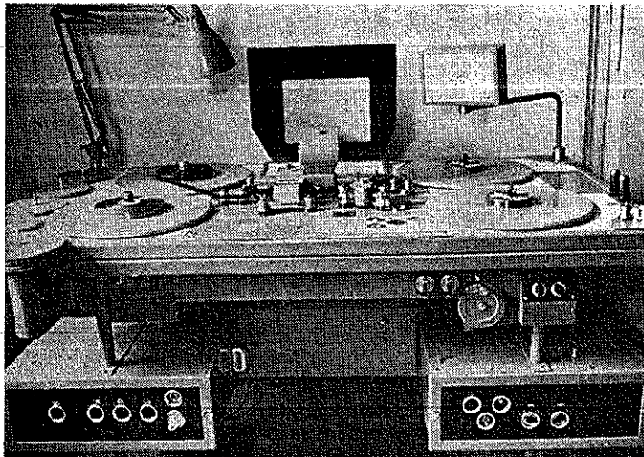
c) Film. stříhací stůl polské konstrukce a výroby Spéfika na 16mm formát filmu. Vzdá obrazový, vpředu zvuk. pás světelný, n. opt.
