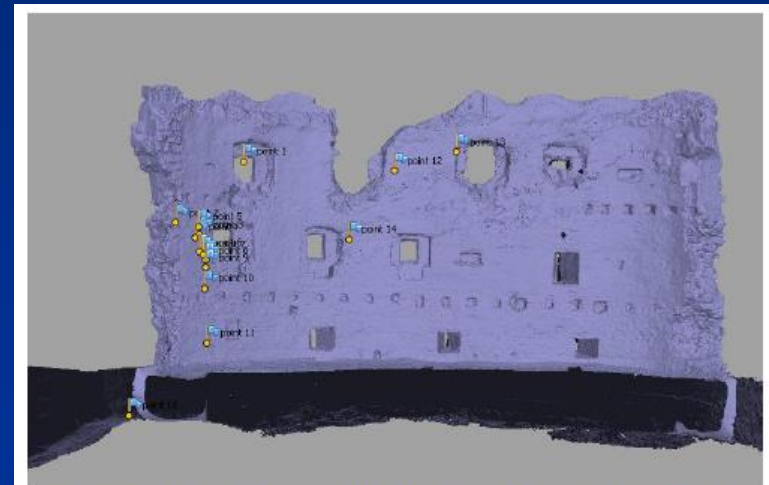
Obr. 40: Referenční body lokalizované na povrchu 3D modelu. Vnitřní stěna paláce hradu Dalečín (autor: V. Nosek).
