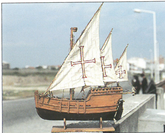
Caravela — navio com dois ou três mastros e velas triangulares (século XV).
