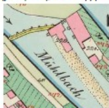
Obr. 4. Mlýnský potok, mlýn se značkami vodních kol, a dřevěný jez (žitě). ⑨⑩.
