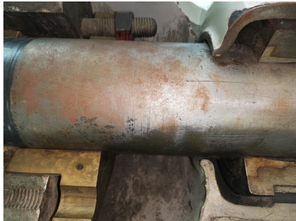
Slabé vrstvy rzi vlivem lokálního znečištění povrchu
