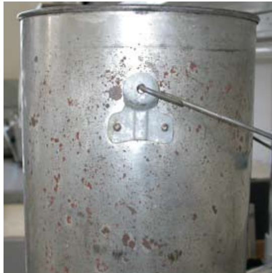
Koroze železa na cínované nádobě a kování
