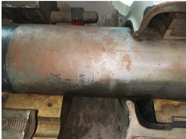
Slabé vrstvy rzi vlivem lokálního znečištění povrchu
