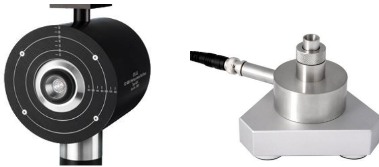
Obr. 1: Umělé ucho pro měření circum-aurálních a supra-aurálních sluchátek (vlevo) a sluchátek do uší (vpravo).
