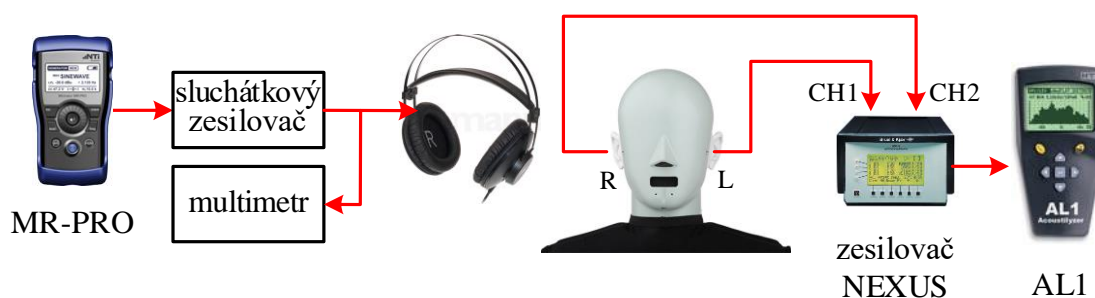
Obr. 3: Zapojení pracoviště pro měření kmitočtových charakteristik sluchátek na umělé hlavě.
