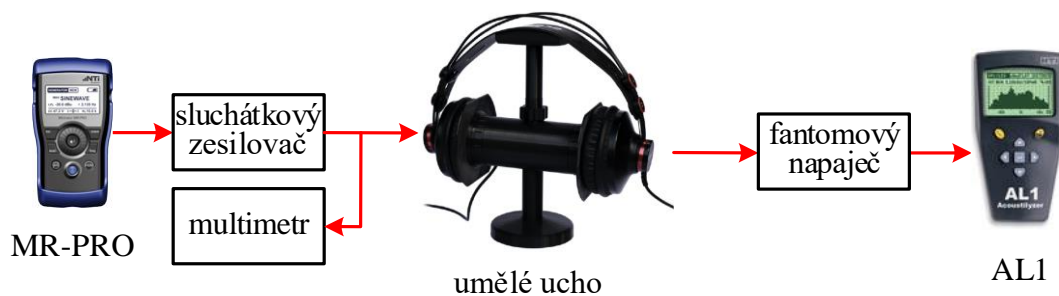
Obr. 5: Zapojení pracoviště pro měření kmitočtových charakteristik sluchátek na umělé hlavě.
