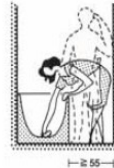
Místo mezi vanou a stěnou
