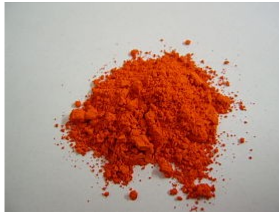
Suřík-minium, oxid olovnato-olovičitý, pigment, antikoroziční povrchová úprava (wikipedia)
