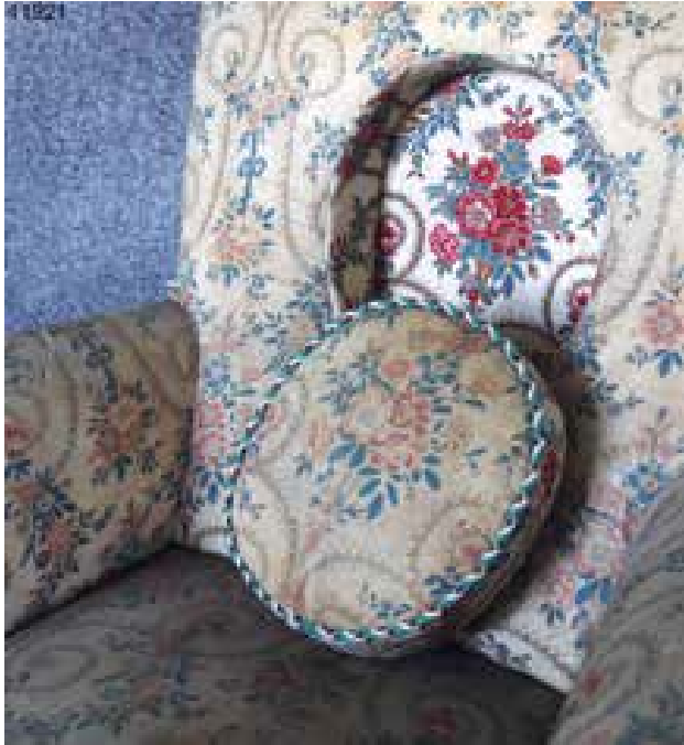
Detail čalounění křesla s barvami vybledlými dlouhodobým působením světla
