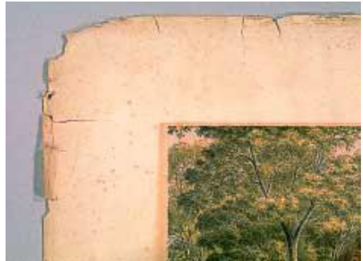
Hydrolytický rozklad papíru, zkřehnutí
