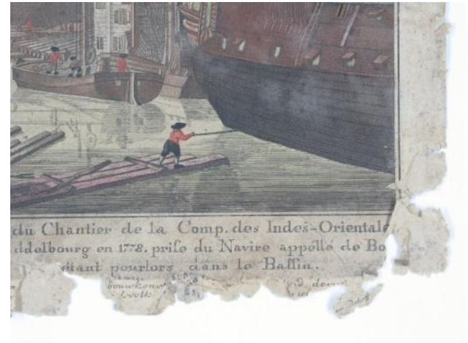
Hydrolytický rozklad papíru, zkřehnutí
