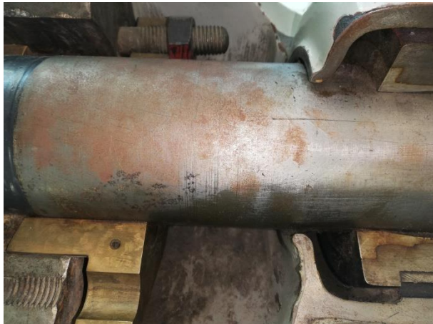
Slabé vrstvy rzi vlivem lokálního znečištění povrchu
