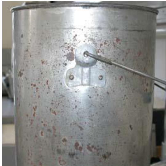
Koroze železa na cínované nádobě a kování
