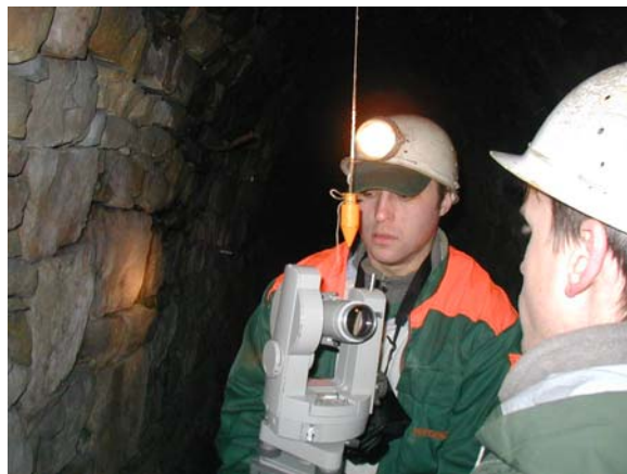
Obr. 9 Centrování teodolitu na střed měřičského hřebu pomocí olovnice.
