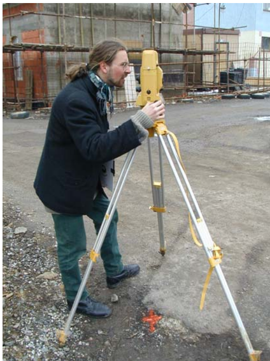
Obr. 3, 4 Připojování štolý od šachty Marie pomocí totální stanice Topcon.
