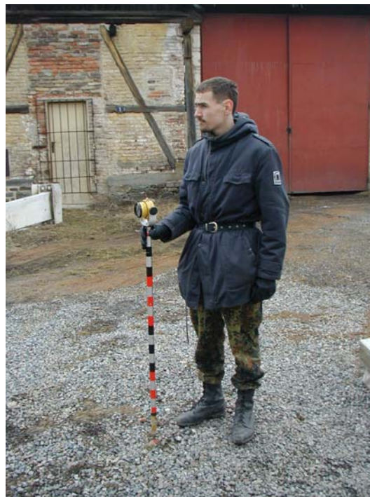
Obr. 3, 4 Připojování štolý od šachty Marie pomocí totální stanice Topcon.
