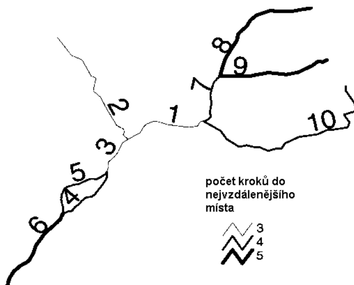
Obr. 3.6 Dostupnost jednotlivých segmentů sítě charakterizovaná počtem kroků nutných k dosažení nejvzdálenějšího místa sítě.
