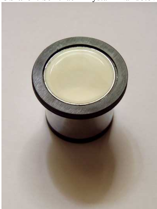
Obrázek: Scintilační krystal z NaI dotovaný thaliem
