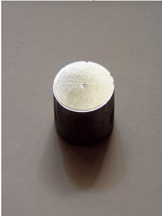
Obrázek: Germaniové jádro Ge(Li) detektoru
