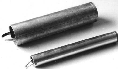
Vzorkovací válce pro odběr vody z hladiny
