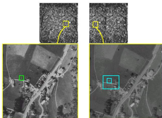
Obr. 10.4. Princip obrazové korelace – referenční a vyhledávací okno
