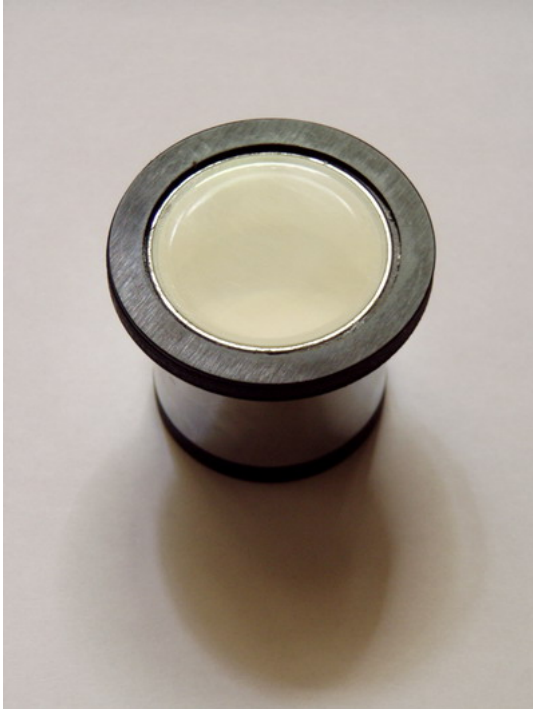
Obrázek: Scintilační krystal z NaI dotovaný thaliem
