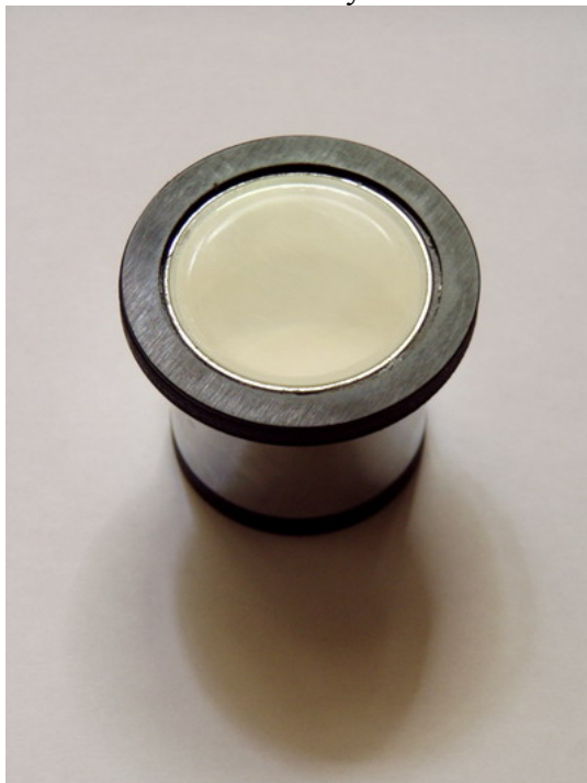
Obrázek: Scintilační krystal z NaI dotovaný thaliem
