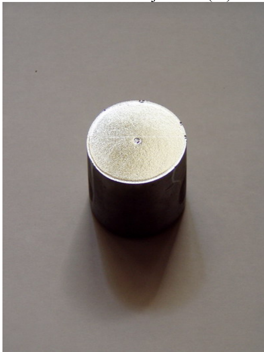
Obrázek: Germaniové jádro Ge(Li) detektoru
