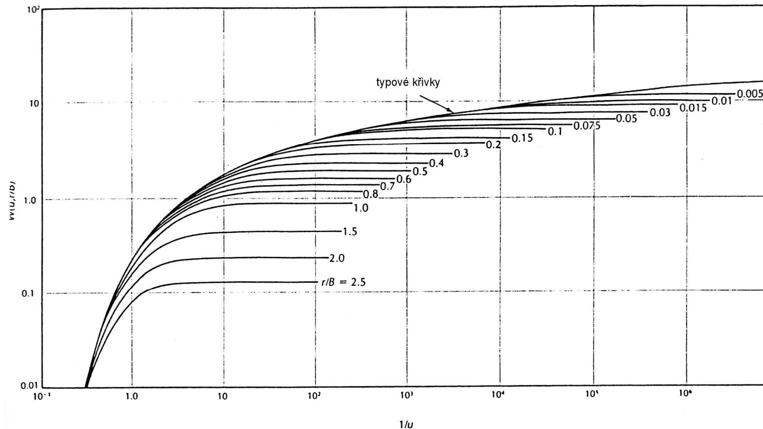
**Identický tvar křivky je rovněž pro případ mezivrstevního přetékání**
