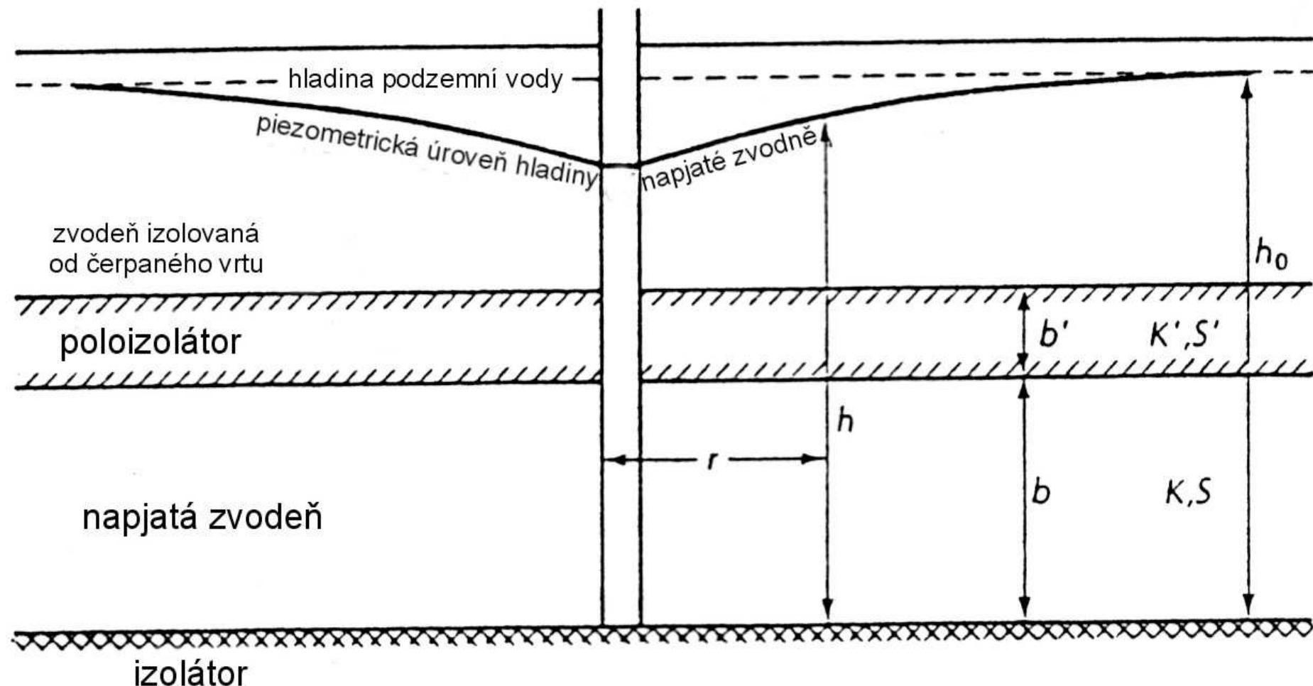
při mocnosti poloizolátoru  $b'$  je vertikální hydraulický gradient napříč poloizolátorem roven  $dh/dz = s/b'$
