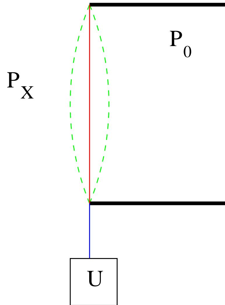
**Princip: deformace membrány s piezo-prvkem**
