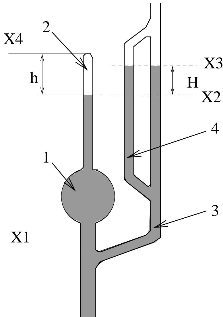
**Komprese plynu se provádí pomocí Hg, V okamžiku, kdy zvedaná rtuť projde rovinou X1, uzavře objem baňky a kapiláry, kde je tlak  $P_1$ . Při dalším zvedání hladiny působí Hg jako píst a stlačuje vzduch až do kompresní kapiláry - hladina X2. Přitom hladina Hg ve srovnávací kapilaře je v rovině X3. Označme objem nezaplněné kapiláry  $V_2$  a tlak v tomto objemu  $P_2$ .**
