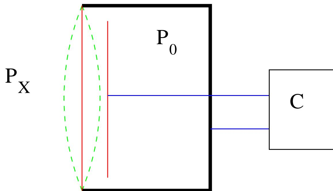
**Princip: deformace membrány a měření její kapacity**
