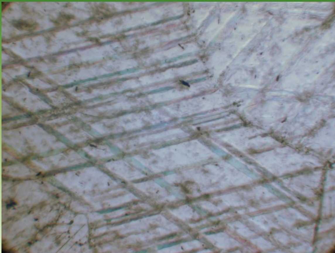
tlakové dvojčatění kalcitu; PPL
