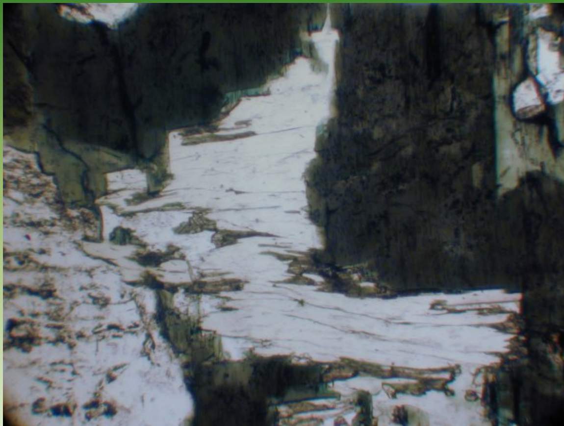
agregát chloritu (kolmo na štěpnost, světlý odstín), amfibol; PPL
