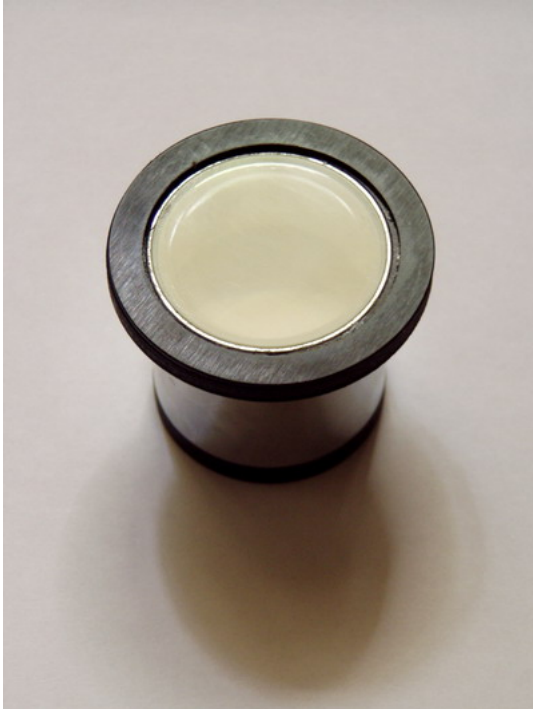
Obrázek: Scintilační krystal z NaI dotovaný thaliem
