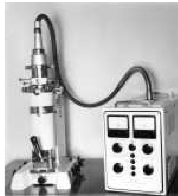
Stolní elektronový mikroskop Tesla BS242 (1954)
