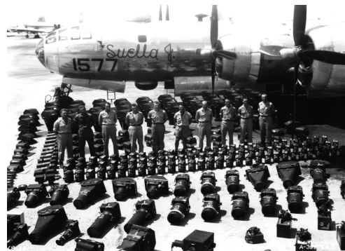
Boeing B-29 a jeho fotogrammetrická výbava, 1946
