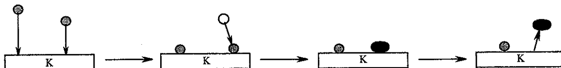
Obr. 6.31. Schéma mechanismu povrchové bimolekulární reakce podle Rideala a Eleye.
