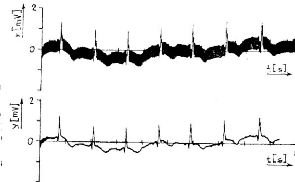
Obr. 5. Filtrace reálného pozátěžového signálu znehodnoceného síťovým brumem úzkopásmovou zádrží H_{12,5}^{(2)} f_{VZ} = 250 Hz, kvantovací krok 5 \mu V )
