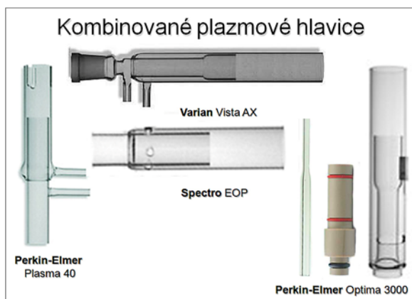
Obr. 6c. Kombinované plazmové hlavice firem Perkin Elmer, Spectro, Varian
