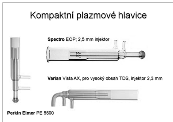
Obr. 6a. Kompaktní plazmové hlavice spektrometrů firem Perkin Elmer, Spectro, Varian
