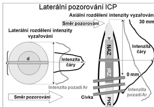
Obr. 13. Prostorové rozdělení emise v ICP výboji, laterální pozorování výboje, laterální a axiální rozdělení intenzity spektrální čáry a rekombinačního kontinua argonu
