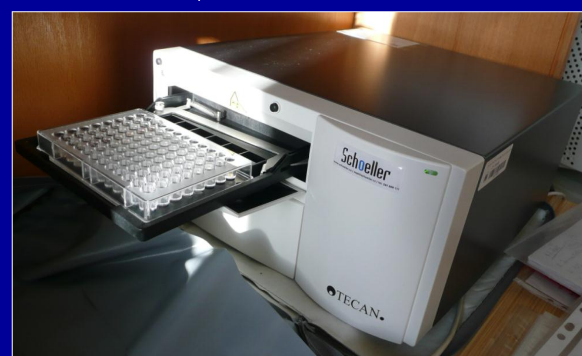
Obr. 8: Destičkový spektrofotometr používaný pro měření změn absorbance vzorků.
