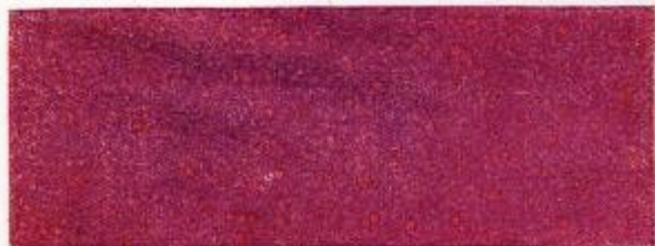
Bild 33. Losterkennungsanstrich mit Stickstofflost besprüht
