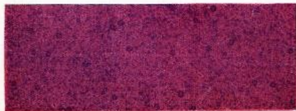
Bild 34. Losterkennungsanstrich mit anderem Geländekampfstoff besprüht
