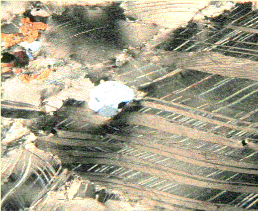
Tlakové dvojčatění: V důsledku tlaku dojde k potočení částí mřížky původně jednoduchého krystalu a vzniku dvojčete.
