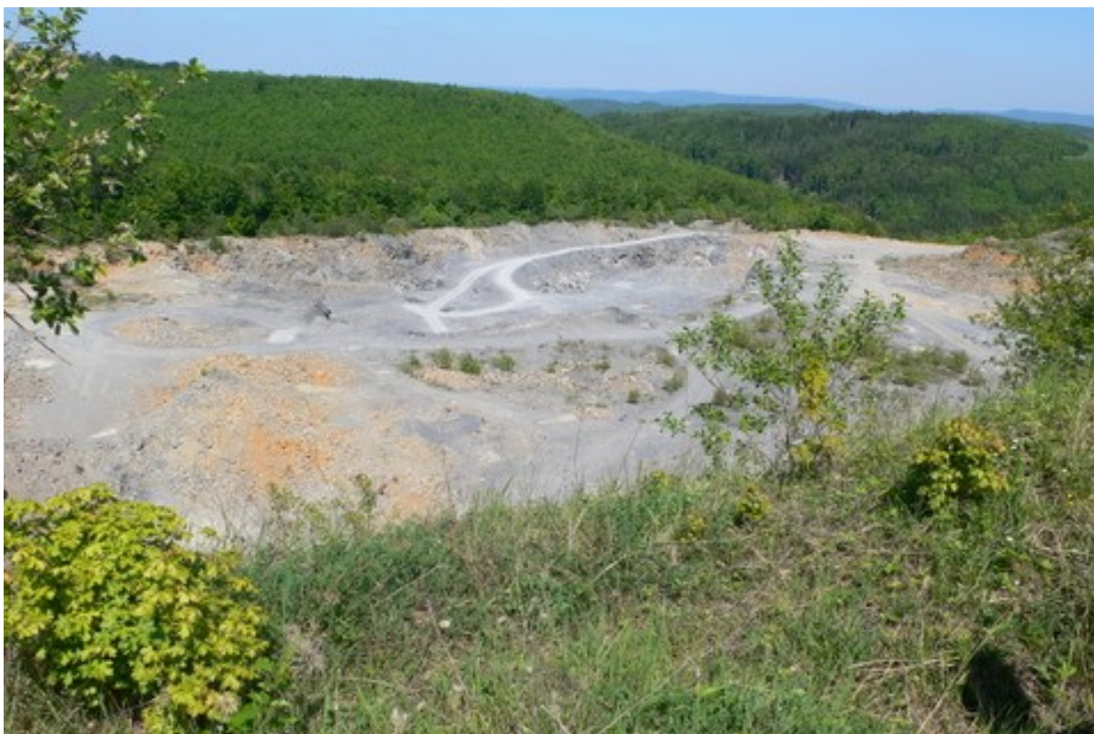
Obr. 7.: fungující lom na vápenec – ovlivňuje okolí mechanicky (nákladní doprava, ražba, prach), ale stejně jako starý kaolinový důl může narušit hladinu podzemní vody nebo jeskynní a krasové systémy v podloží. Dále je také pravděpodobně budoucí oblastí svahových pohybů.
