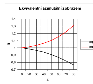
Obr. 8-4 Ekvivalentní azimutální zobrazení ( U_0=0^\circ , V_0=0^\circ ) a graf zkreslení v rovnoběžkách a polednicích
