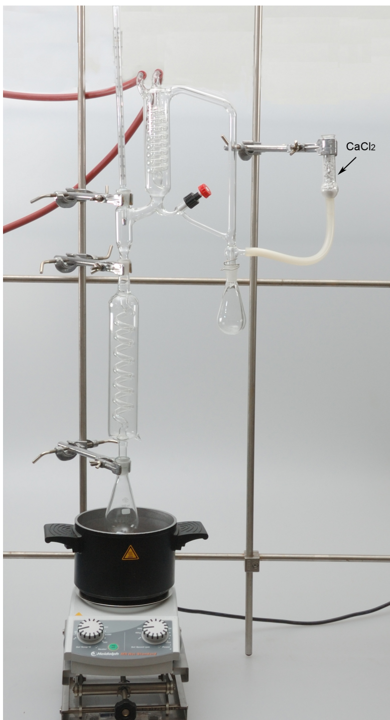
Obrázek 8: Aparatura pro rektifikaci azeotropní směsi B(OCH_3)_3 + CH_3OH .
