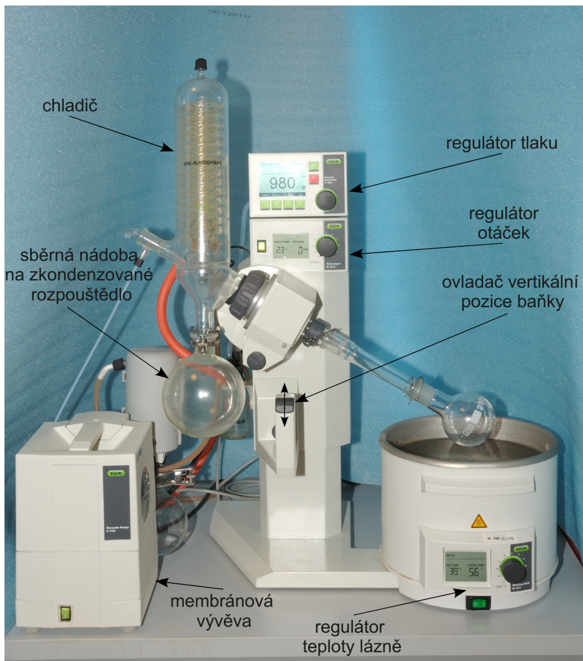
Obrázek 34: Rotační vakuová odparka.
