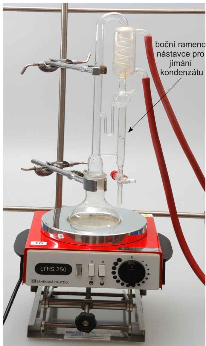
Obrázek 32: Aparatura pro azeotropní destilaci s rozpouštědly lehčími než voda.
