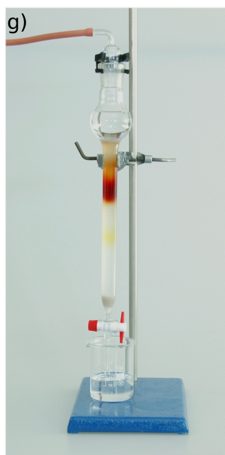
Obrázky 36e–h: Dělení azobarviv pomocí sloupcové chromatografie.
