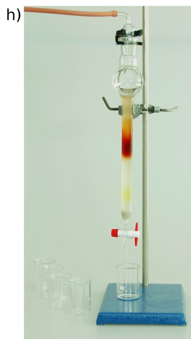
Obrázky 36e–h: Dělení azobarviv pomocí sloupcové chromatografie.
