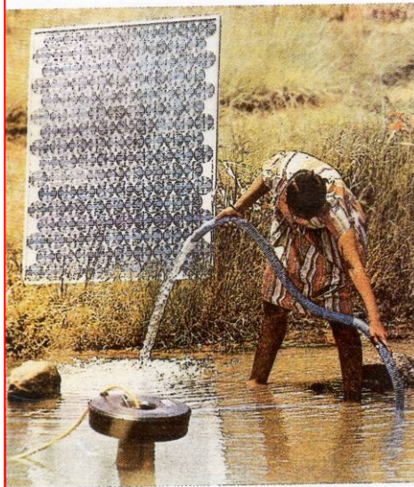
Zavodňovací čerpadlo poháněné elektřinou ze solárního panelu.
