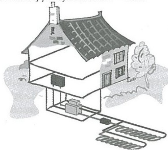
Obr. 8 Primární zdroj pro systém země – voda.
