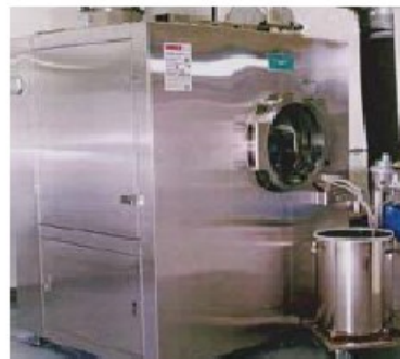
Princip potahování tablet a potahovací zařízení
