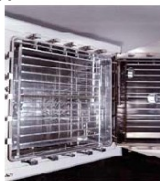
Průmyslové lyofilizační zařízení pro výrobu "suchých" injekcí
