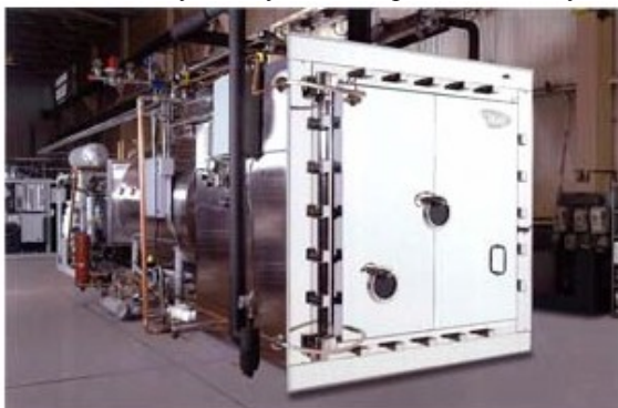
Průmyslové lyofilizační zařízení pro výrobu "suchých" injekcí
