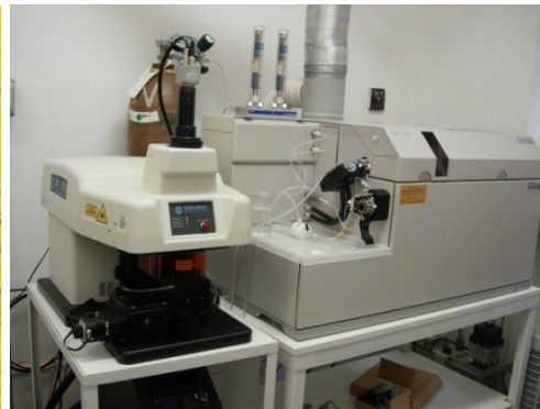
ICP-MS Agilent 7500 ce
