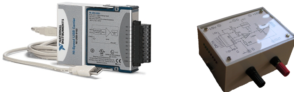
Obrázek 2.3: Dva D/A převodníky: vlevo profesionální 4-kanálový 16-bitový převodník USB-9263 firmy National Instruments, vpravo jednoduchý osmibitový D/A převodník MDAC-08
