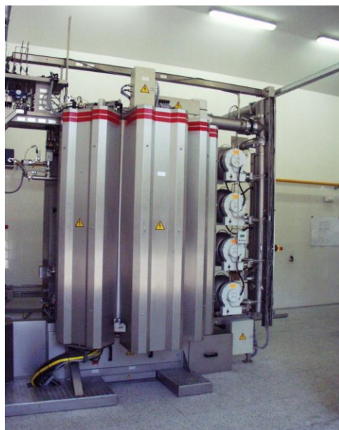
Obr. 1 – priemyselné zariadenie na magnetronové naprašovanie firmy HVM v Modřicích
