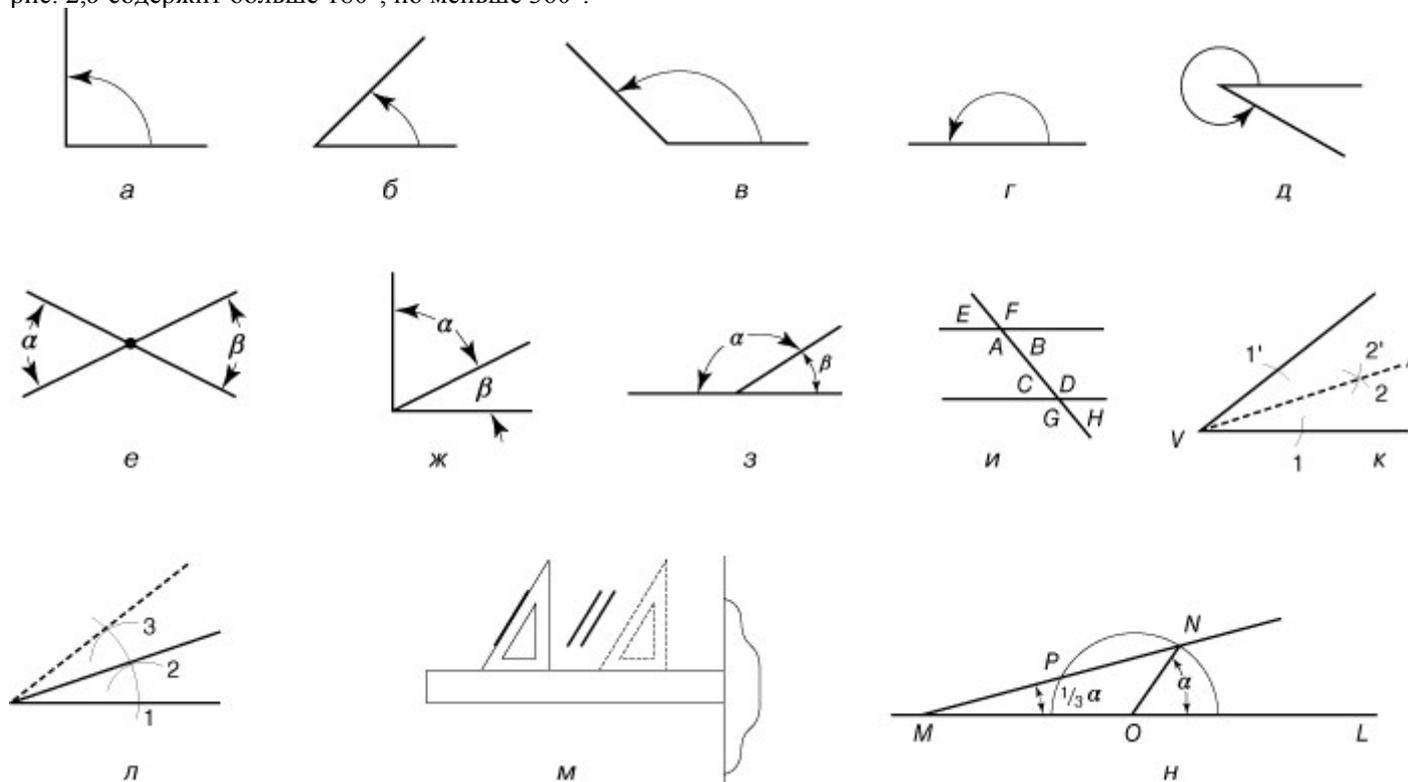
Рис. 2. УГЛЫ. а – прямой угол; б – острый угол; в – тупой угол; г – развернутый угол; д – угол, больший  $180^\circ$  и меньший  $360^\circ$ ; е – вертикальные углы; ж – дополнительные углы (до  $90^\circ$ ); з – смежные углы (до  $180^\circ$ ); и – углы, образованные при пересечении параллельных прямой; к – деление угла пополам; л – удвоение угла; м – вычерчивание параллельных с помощью треугольника и рейсшины; н – трисекция угла по Архимеду.
