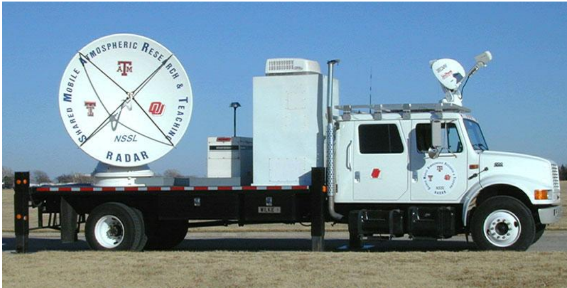
Obr. 34 Mobilní radar NSSL.
