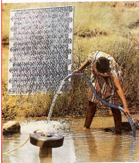
Zavodňovací čerpadlo poháněné elektřinou ze solárního panelu.
