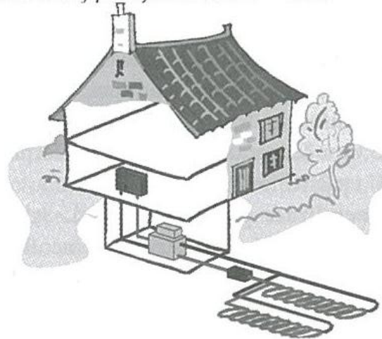
Obr. 8 Primární zdroj pro systém země – voda.
