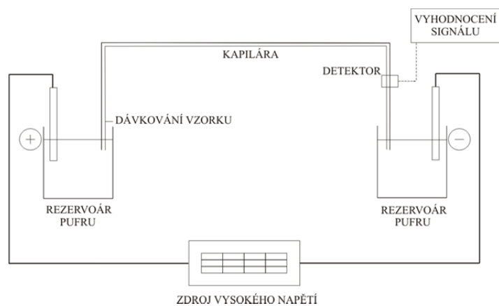
Obrázek 1: Schéma kapilární elektroforézy.
