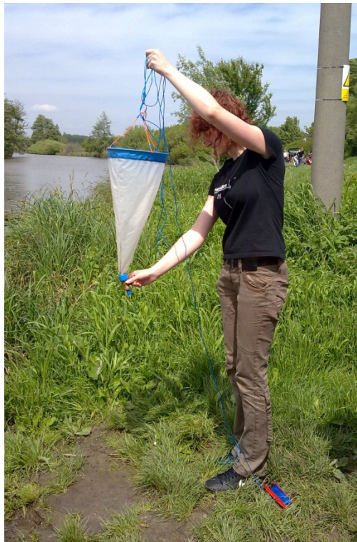
Obrázek 7: odběr zooplanktonu a fytoplanktonu pomocí planktonní sítěky
