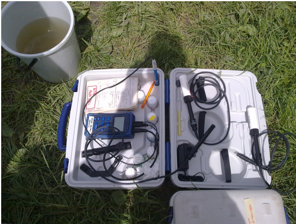
Obrázek 8: Souprava pro měření základních parametrů vzorků vod
