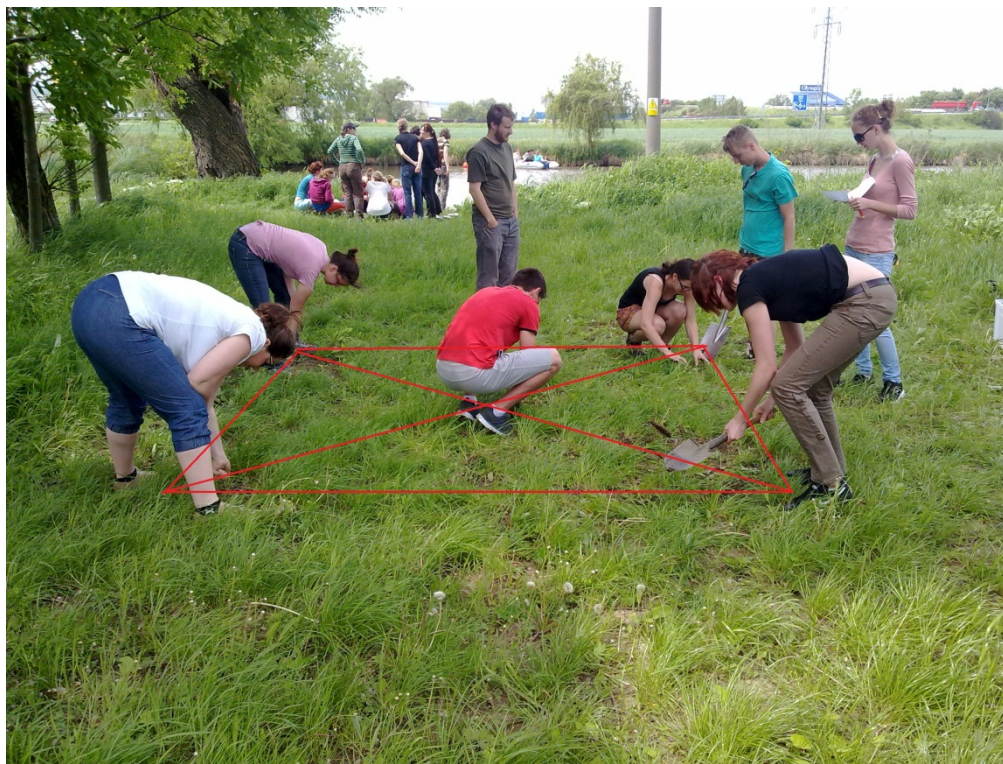
Obrázek 5: Vzorkovací síť pro odběr vzorků půd
