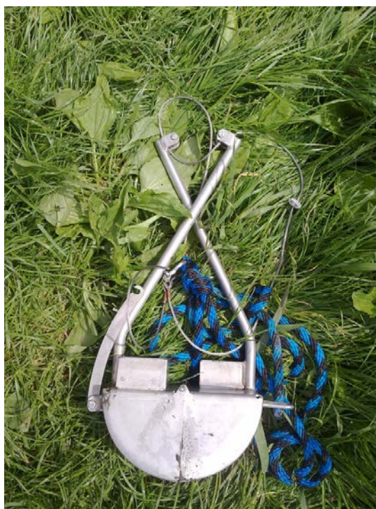
Obrázek 4: Drapák pro vzorkování sedimentu
