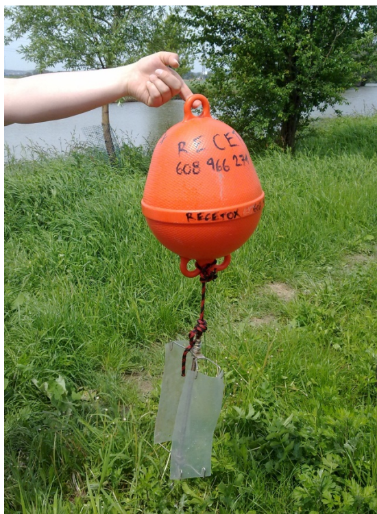
Obrázek 3: Pasivní vzorkovač vody se silikonovou gumou
