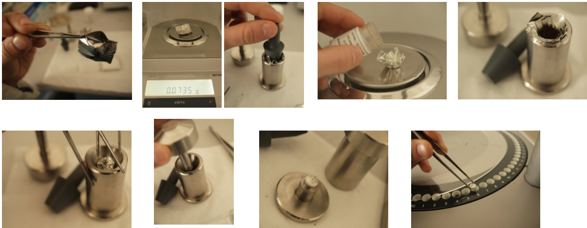
Obrázek 10: Příprava vzorku pro stanovení TC a TOC
