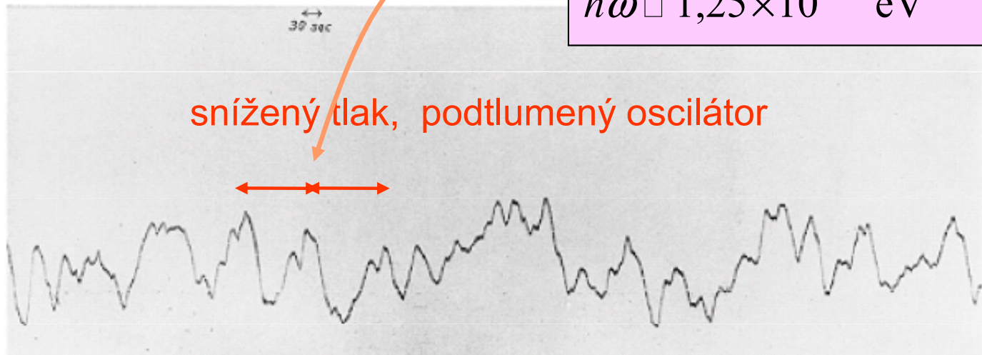
Registrieraufnahme der Brownschen Bewegung (natürliche Größe). Direktionskraft 2,66 \cdot 10^{-9} abs. Einh. Trägheitsmoment 6,1 \cdot 10^{-6} abs. Einh. Abstand Spiegel-Kamera: 86,5 cm. Zeitmarke: 30 sec d x = 2 mm. b) 4 \cdot 10^{-3} mm Hg. Temperatur 10^{\circ} \text{C}
