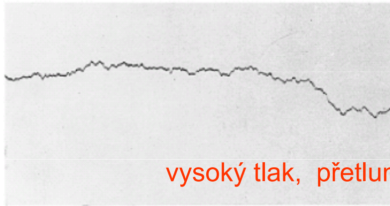
Registrieraufnahme der Brownschen Bewegung Direktionskraft 2,66 \cdot 10^{-9} abs. Einh. Trägheitsmoment 6,1 Zeitmarke: 30 sec d x = 2 mm. a) Atmosphä Fig. 4a
