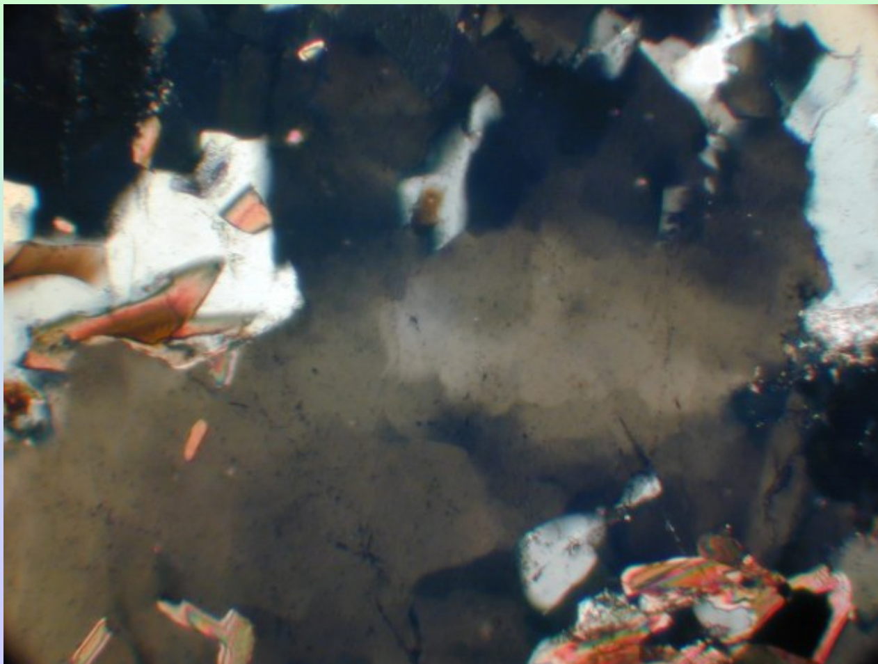
undulózní zhášení křemene v rule, XPL
