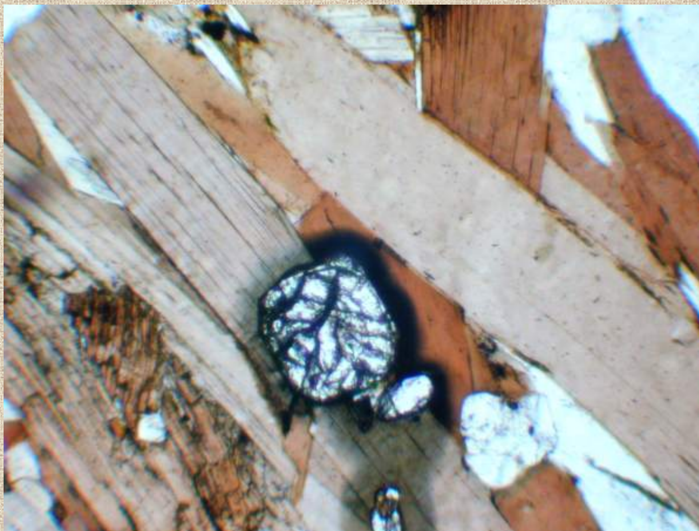
automorfnní zrno zirkonu v biotitu se zřetelným pleochroickým dvůrkem, rula, Štramberský u Sněžného, PPL
