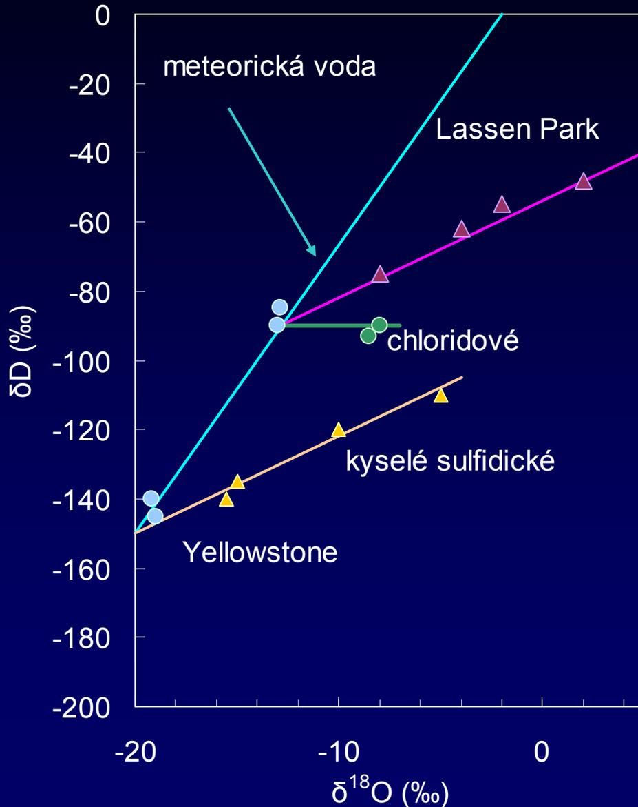
Frakcionace  $\delta D$  a  $\delta^{18}O$  v meteorických hydrotermálních systémech. K frakcionaci dochází v důsledku zahřívání, varu a míšení vod.
